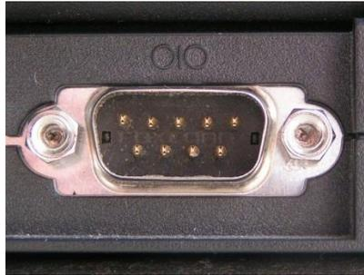
Un puerto serie o puerto en serie es una interfaz de comunicaciones de datos digitales, frecuentemente utilizado por computadoras y periféricos, donde la información es transmitida bit a bit, enviando un solo bit a la vez; en contraste con el puerto paralelo que envía varios bits simultáneamente.
