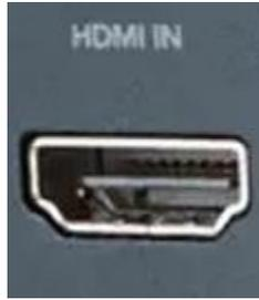
El **puerto HDMI** es la interfaz multimedia de alta definición, actualmente es muy usada debido a que permite la conexión entre diversos aparatos en alta calidad. El **HDMI** transmite audio y video con un único cable, desde la computadora a pantallas de TV.
