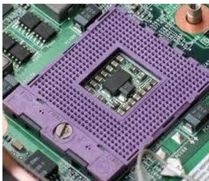
El **zócalo de CPU** (*socket* en inglés) es un tipo de zócalo electrónico (sistema electromecánico de soporte y conexión eléctrica) instalado en la placa base, que se usa para fijar y conectar el microprocesador, sin soldarlo lo cual permite ser extraído después. Por ello, se utiliza en equipos de arquitectura abierta, donde se busca que haya modularidad en la variedad de componentes, permitiendo el cambio de la tarjeta o el integrado.
