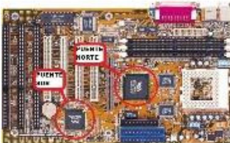
Básicamente, **Chipset** es el nombre que se le da al conjunto de chips (o circuitos integrados) utilizado en la placa madre y cuya función es realizar diversas funciones de hardware, como control de los Bus (PCI, AGP y el antiguo ISA), control y acceso a la memoria, control de la interfaz I/O y USB, Timer, control de las señales de interrupción IRQ y DMA, entre otras.
