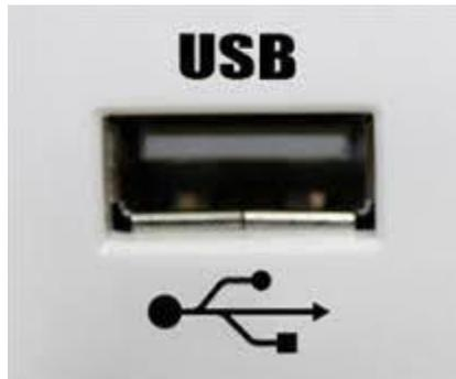
El Bus Universal en Serie, más conocido por la sigla USB, es un bus de comunicaciones que sigue un estándar que define los cables, conectores y protocolos usados en un bus para conectar, comunicar y proveer de alimentación eléctrica entre computadoras, periféricos y dispositivos electrónicos.
